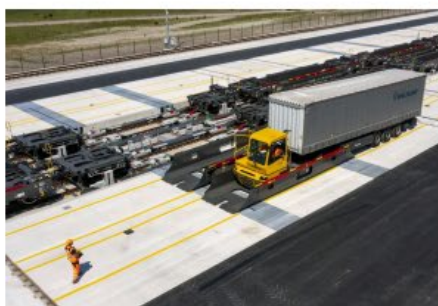
Manutention horizontale avec installation au sol et ouverture par translation (Energie électrique)
